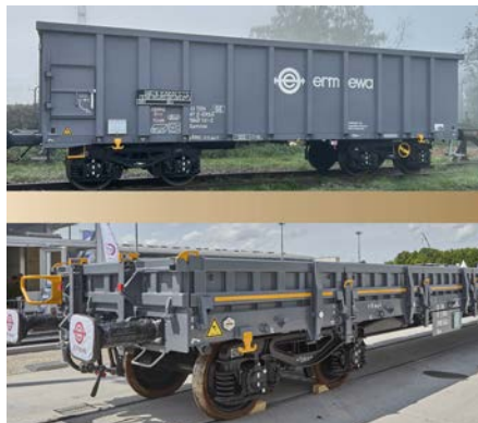
ERMEWA expose le wagon tombereau Eamnos (71 tonnes de charge utile pour le transport de matériaux en vrac) et le wagon plat Rens pour les chantiers ferroviaires.
