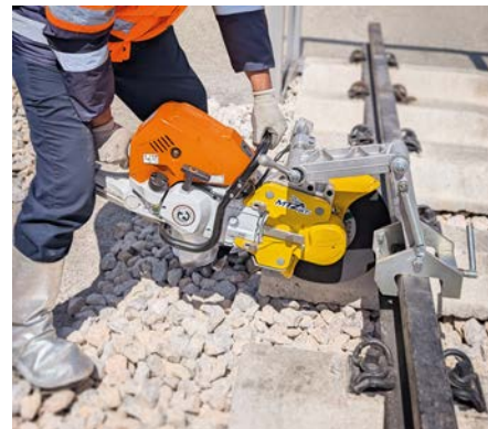
GEISMAR révèle la tronçonneuse de rail MTZ GTi, pour couper un rail UIC60 en moins de 60 secondes.
