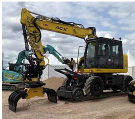
ACX présente la pelle 24RR (norme EN 15746) avec une stabilité exceptionnelle et une grande capacité de levage.
