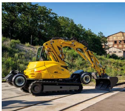
MECALAC achemine la pelle 136M rail conçue pour les travaux ferroviaires dans des espaces restreints.
