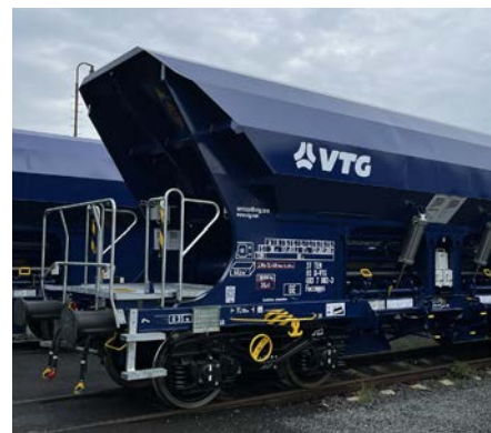
VTG expose le nouveau wagon-trémie Faccnps, optimisé pour le transport de matériaux en vrac.
